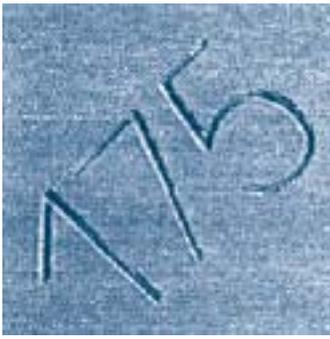
Abb. 2: Mit der Spitze eines Rasterkraftmikroskopes in Glimmer eingefräste Struktur. Die Linienbreite beträgt nur ca. 8 nm [10, 11, 12].
