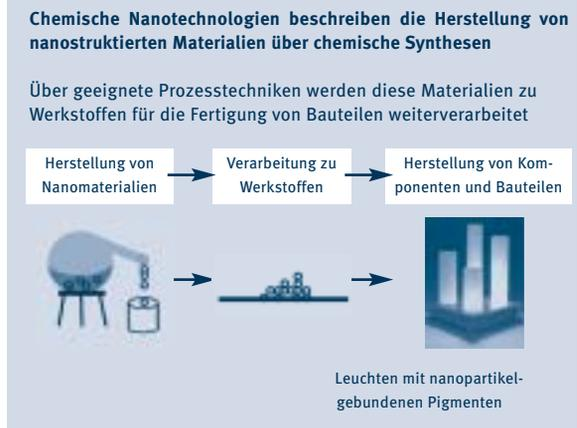
Bild 1: Definition und Beispiel für eine chemische Nanotechnologie vom Ausgangsprodukt zum Bauteil
