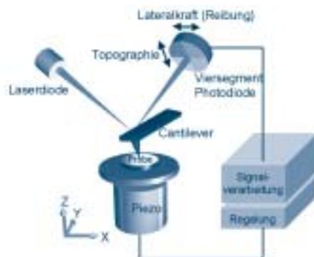
Abb. 1: Schematischer Aufbau eines Rasterkraftmikroskopes
